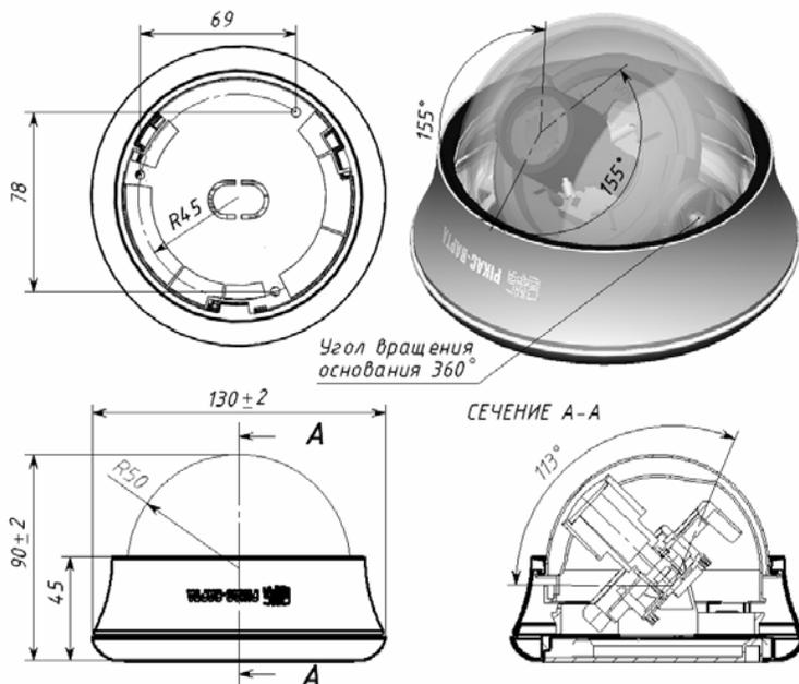
Особенность конструкции камеры - «3D» кронштейн, который позволяет вращать модуль телекамеры вокруг оптической оси объектив, поэтому камера может монтироваться под углом к поверхностям наблюдения, в т.ч. и на стену.
