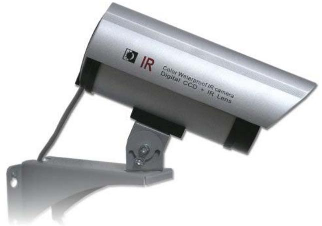
Крепление камеры к кронштейну RH-110 через встроенный в корпус пластиковый изолятор
