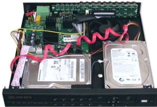
Внутреннее устройство видеорегистратора
