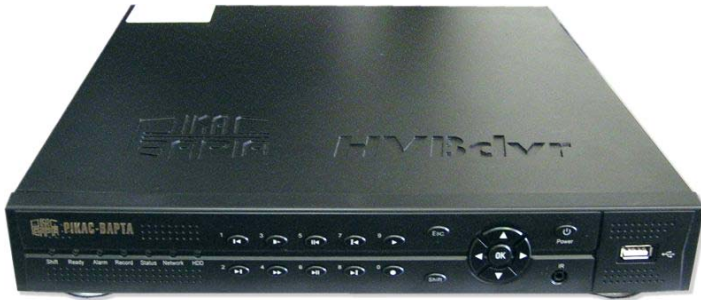
Вид спереди (индикаторы состояния, цифро-функциональная клавиатура, кнопки управления и курсора, приемник ИК сигнала, USB 2.0 порт)
