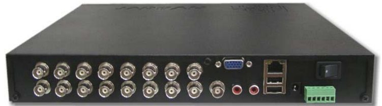
Вид сзади (входы и выход видео, вход и выход звука, VGA-выход, сеть, два интерфейса USB, RS-485, вх./вых. тревог, вход питания 12 В)
