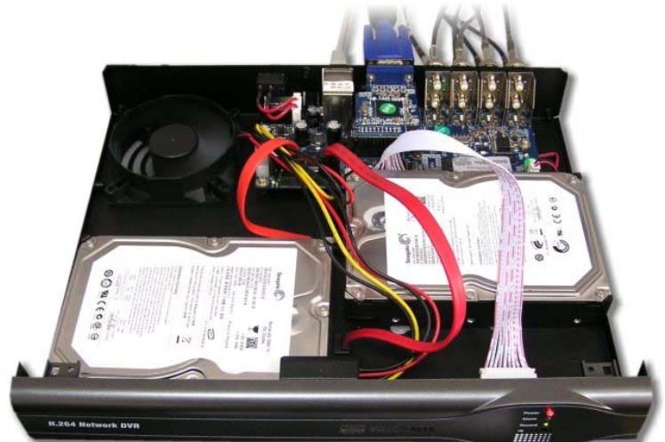
Устройство видеорегистратора – установлено 2 жестких диска
