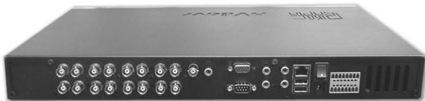
где, Video In 1..16 - разъемы для подключения видеосигналов, V-Out – выход для подключения видеорегистратору телевизора или аналогового монитора, VGA – выход для подключения к регистратору «компьютерного» монитора, A-In-1 – A-In-4 и A-Out – соответственно 1-4 входы и выход для подключения звукового сигнала и активных колонок, сетевой разъем, разъем USB (верхний разъем для подключения «мышки», нижний для внешнего устройства копирования), DC-12V - разъем напряжение электропитания 12 В.
