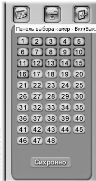
Цифры в панели соответствуют номерам видеокамер. Если цифра выделена синим цветом, то за ранее выбранную дату в архиве для этой камер присутствуют видеозаписи, если цифра желтая – то видеозаписей нет.
