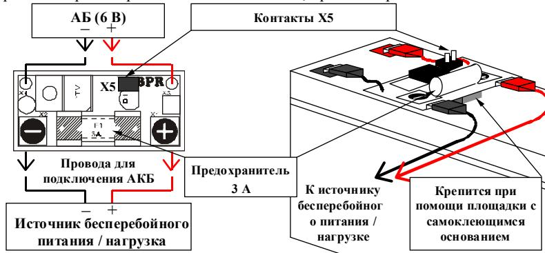
5.3 Подключить зарядное устройство или нагрузку к клеммам устройства, обозначенным на плате как “+” и “–”, соблюдая полярность.
