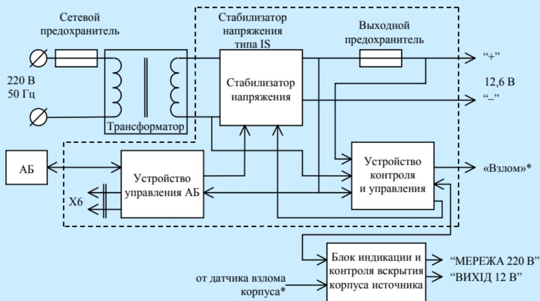
**Рисунок 2. Схема источников бесперебойного электропитания тип IPS**
