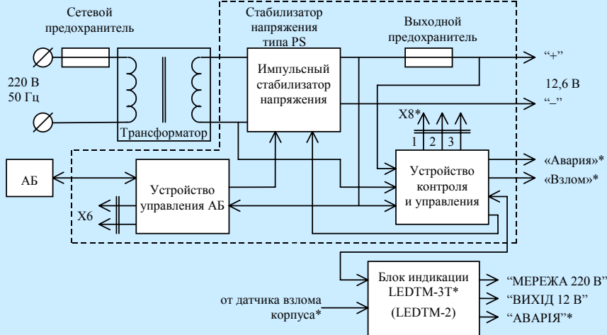
Рисунок 2. Схема источников бесперебойного электропитания тип PPS
