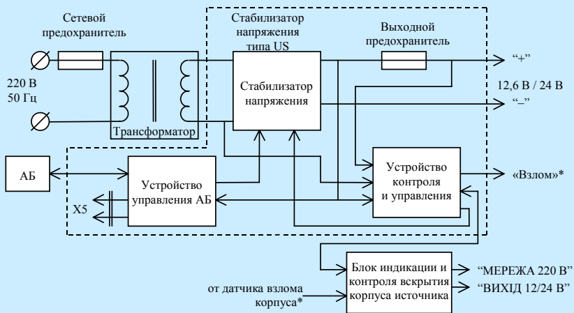
Рисунок 2. Схема источников бесперебойного электроснабжения тип UPS
